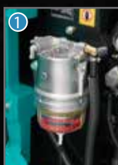
① Voorfilter met ingebouwde waterafscheider
