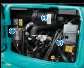
① Voorfilter met ingebouwde waterafscheider
